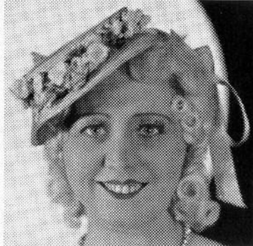
Druckstock mit 60er Raster (60 Punkte = 1 cm)
